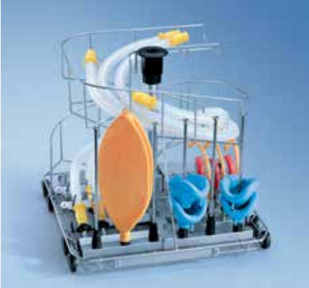
E 435/3 mobil enjektör birimi TA G 7892, G 7882 CD ve PG 8535'te kullanılmak için • Yaklaşık 2 AN takımı için • Solunum tüpleri için yay uçlu 6 fıskiye, yaklaşık uzunluk 1.5 m • Spiral destek • Sıcak hava kurutma bağlantısı • Otomatik mobil birim tanıma/püskürtme kolu algılaması için ML/2 manyetik şerit tutuculu • Y 507, G 535, D 515 mm
